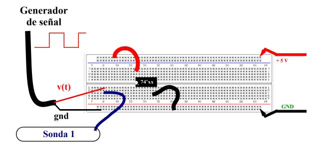
5. Sin quitar la señal cuadrada del canal 1 del osciloscopio, montar el circuito de la práctica, conectar la sonda 2 y probar la operación del circuito. P.ej. el circuito de solo NANDs:
