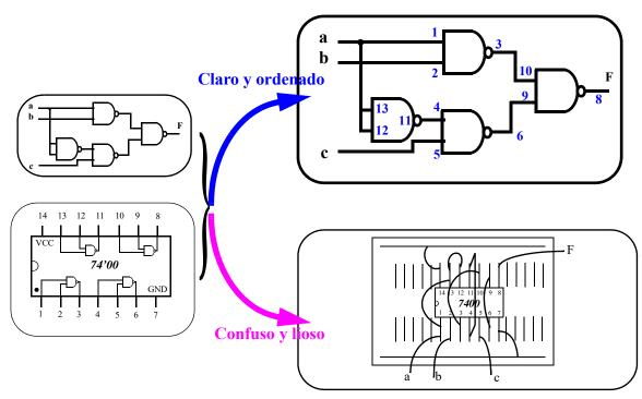
6. Dar valores a las entradas "a, b y c". Por ejemplo, si se quiere poner "a" variando entre 0 y 1, "b" fija a 0 y "c" fija a 1, "a" se conecta a la salida del Generador de señales, "b" a GND y "c" a +5V.
