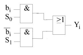
Diseño del "circuito yi" con un multiplexor
