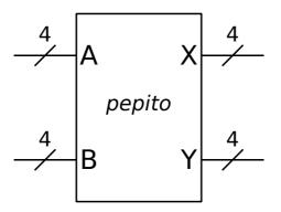
Diseñe un circuito que toma tres números de 4 bits A, B y C como entradas y proporciona como salida dos números de 4 bits X e Y tales que X es el mayor de A, B y C, e Y es el menor de A, B y C. Diseñe y dibuje el circuito usando el módulo pepito diseñado en el ejemplo 2 como bloque básico.
