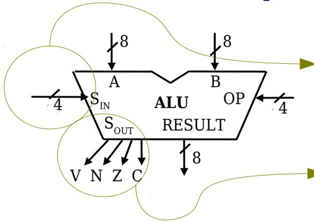
$S_{IN} = \{V_{IN} N_{IN} Z_{IN} C_{IN}\}$  Salida del registro De estado, SR, que almacena Sout.
