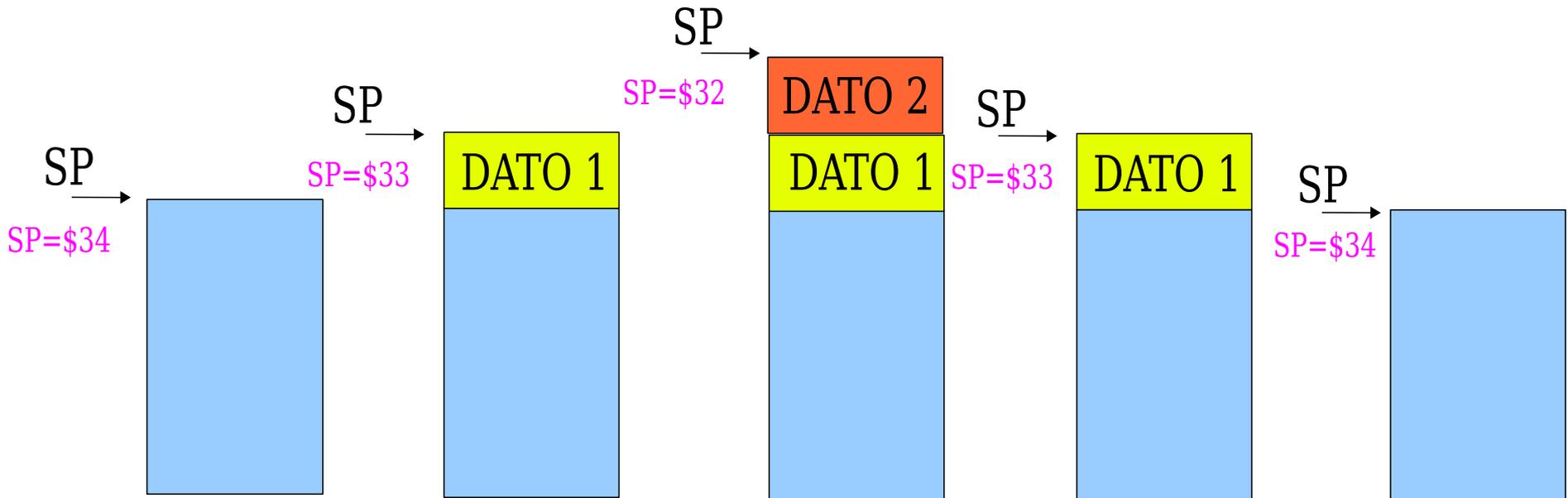
Resumen del proceso de dos operaciones de escritura en pila (PUSH) y otras dos de lectura de pila (PULL).
