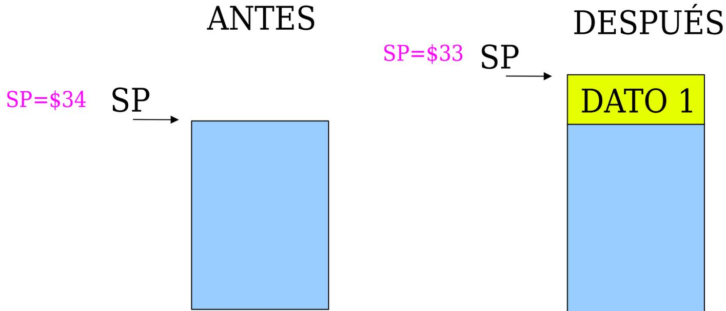
Proceso de guardar datos en la pila. Operación de PUSH
