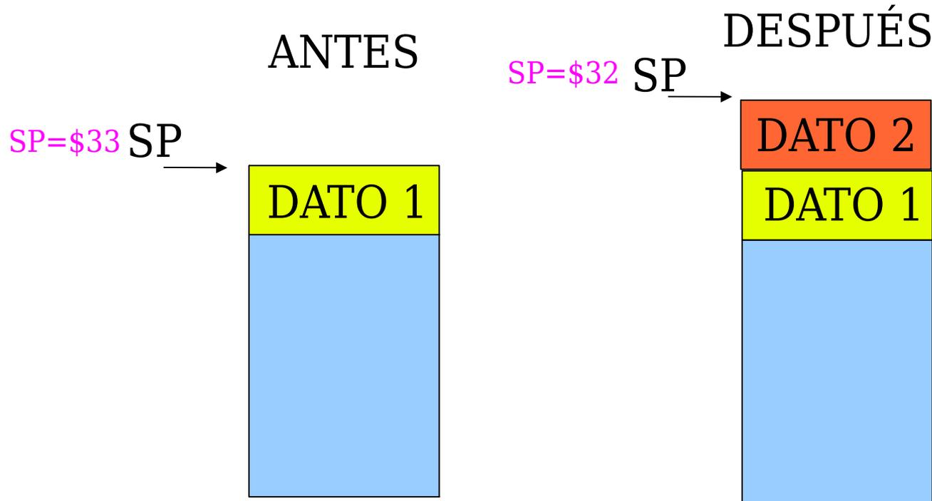
Proceso de guardar datos en la pila. Operación de PUSH
