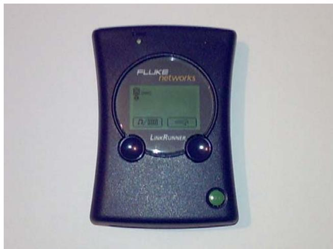
a. Use una derivación de cable de conexión directa que no esté conectada a ningún panel de conexión, hub o switch en el otro extremo. Conecte uno de los extremos del cable en el puerto LAN RJ-45 del LinkRunner. ¿Qué aspecto tiene la pantalla?
