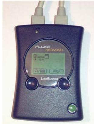
Use los cables de conexión directa defectuosos que les ha proporcionado el profesor. Conecte uno de los extremos del cable en el puerto LAN RJ-45 del LinkRunner y el otro extremo en el puerto MAP RJ-45. ¿Cuáles son los problemas que se detectan en cada caso? Rellene la siguiente tabla.
