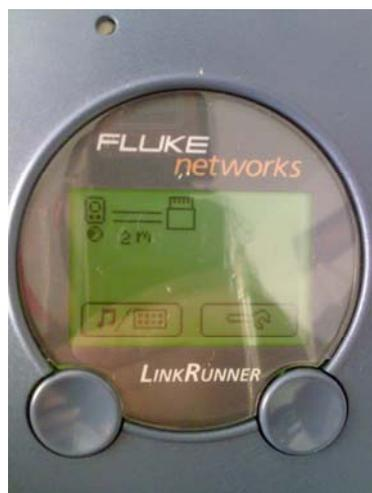
Ahora, use un cable de conexión cruzada en buenas condiciones. Conecte uno de los extremos del cable en el puerto LAN RJ-45 del LinkRunner y el otro extremo en el puerto MAP RJ-45 del LinkRunner. ¿Cuál es la longitud del cable? **La longitud del cable es de 10 metros.**
