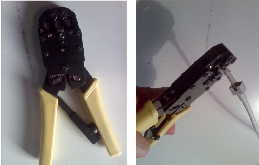
**Punto 9)** Repita los pasos del 4 al 8 para terminar el otro extremo del cable, utilizando el esquema **T568-A** para terminar el cable de interconexión cruzada.
