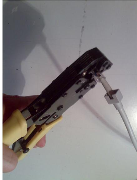
**Punto 8)** Repita los pasos del 3-8 para terminar el otro extremo del cable, usando el mismo diagrama para terminar el cable de conexión directa.
