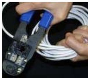
**Punto 3)** Retire 5,08 cm de la envoltura de uno de los extremos del cable.
