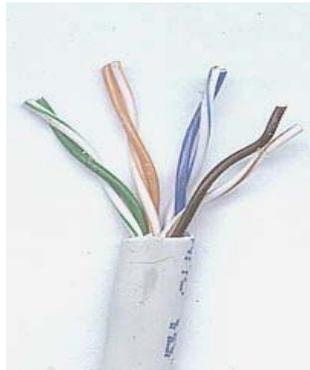
**Punto 2)** Colocar los hilos en los canales correctos del Jack manteniendo las trenzas lo más posible. El siguiente diagrama muestra un ejemplo de cómo colocar los hilos en un tipo de Jack. La mayoría de los jacks traen los canales codificados por color para indicar dónde poner los hilos. La foto del Jack que aparece en la página siguiente muestra un tipo de Jack. Los jacks vienen normalmente estampados para indicar si son de T568A o B, como se ve en la foto.
