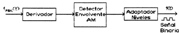
Fig.2-5 Demodulador FSK detección de envolvente.
