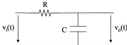
1.2.- Excitar un circuito RC paso de alta como el de la figura con una tensión sinusoidal de 5 voltios de amplitud y frecuencia en un rango significativo de valores. Medir la tensión de salida y su retardo con respecto a la entrada. Calcular la ganancia, el desfase y el retardo del sistema para cada frecuencia. Con estos valores determinar:
