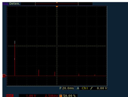
Figura 21. Espectro señal original y recuperada ( $f_s=10\text{KHz}$ )
