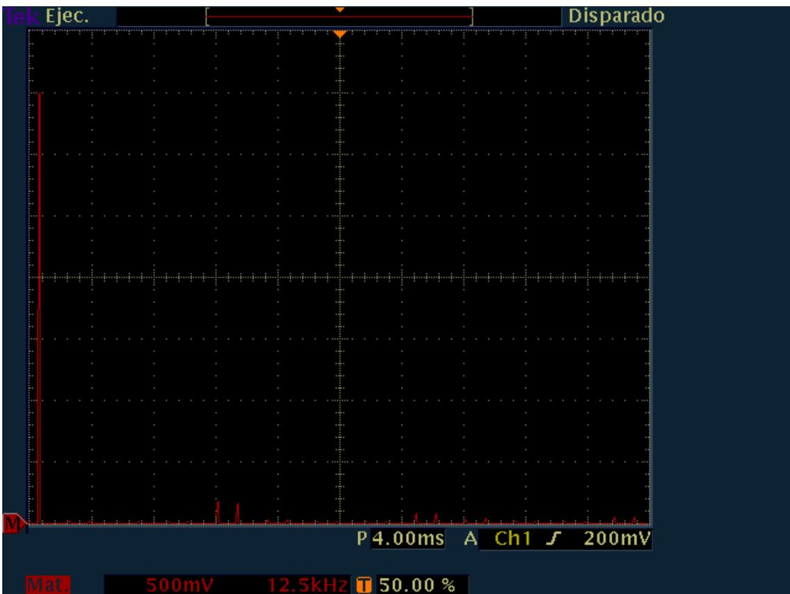
Figura 15. Espectro de la señal muestreada (muestreo plano)
