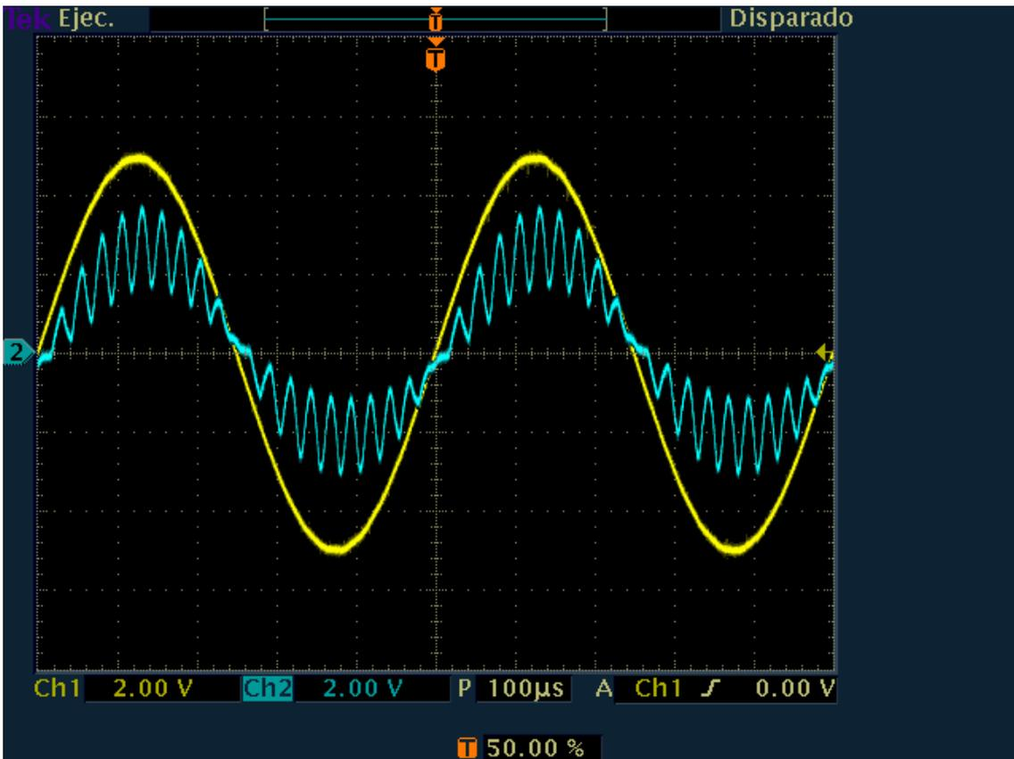
Figura 16. Señal original y recuperada (muestreo natural)
