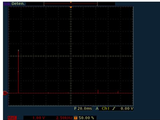
Figura 23. Espectro señal original y recuperada (fs=20Khz)
