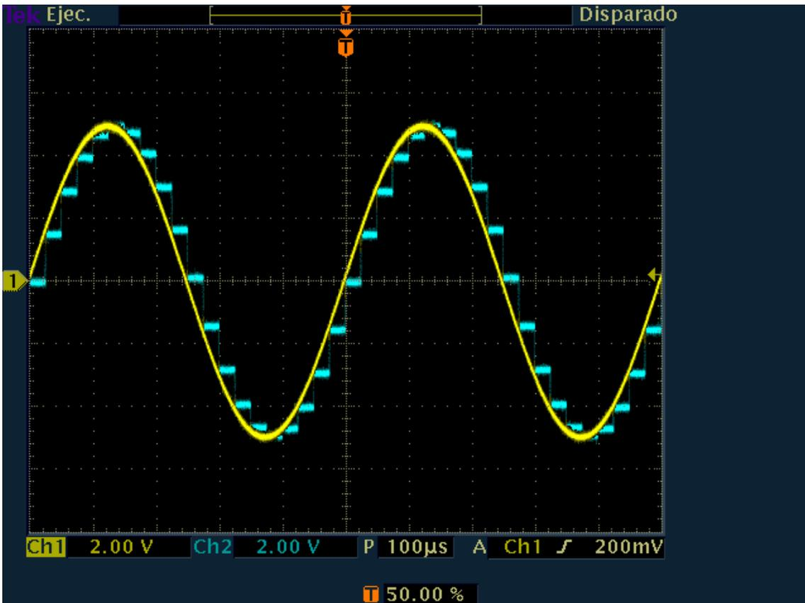
Figura 14. Señal original y muestreada (muestreo plano)
