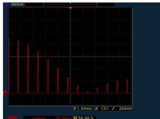
Figura 11. Espectro señal muestreada ( $dc=12\%$ )
