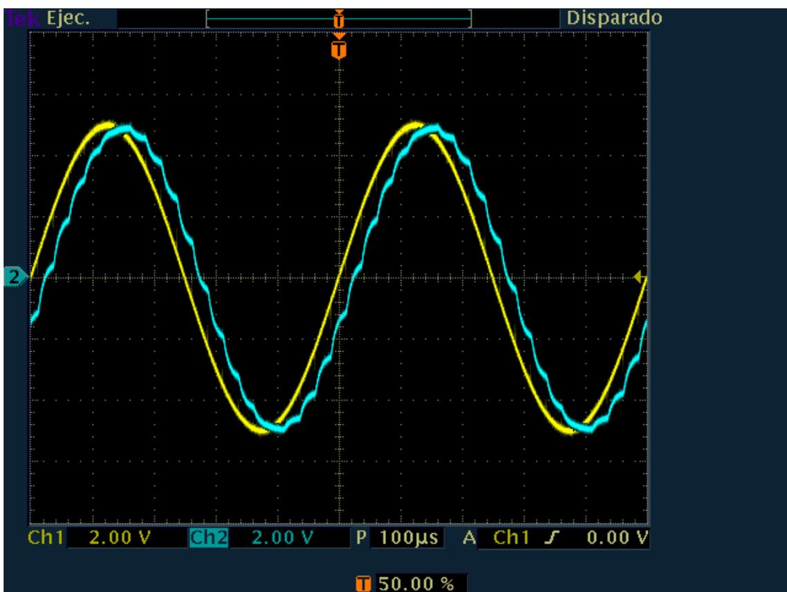
Figura 18. Señal original y recuperada (muestreo plano)
