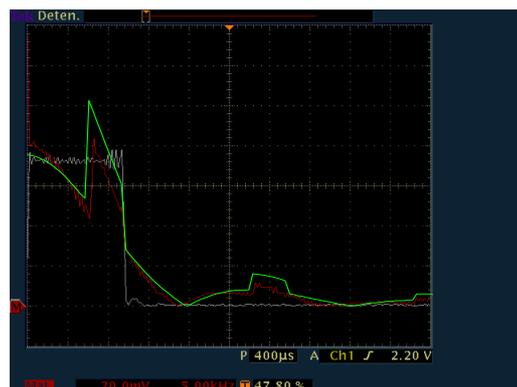
**Figura 36. Espectro señal original y recuperada (experimental y teórico) con muestreo plano**
