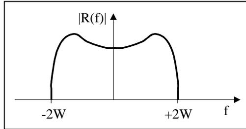
Por otra parte vemos que el segundo sumando de  $v_1(t)$  es la modulación en amplitud de  $r(t)$  con una portadora de frecuencia  $2f_c$ . Por tanto, el espectro de este segundo sumando será el espectro de  $r(t)$  duplicado y desplazado a la frecuencia de la portadora  $2f_c$ . Esto quiere decir que este espectro se extenderá en el rango  $2f_c - 2W < f < 2f_c + 2W$ . La frecuencia mínima de este rango es  $2f_c - 2W$  que, teniendo en cuenta que  $f_c > 2W$ , siempre será mayor de  $2W$ .
