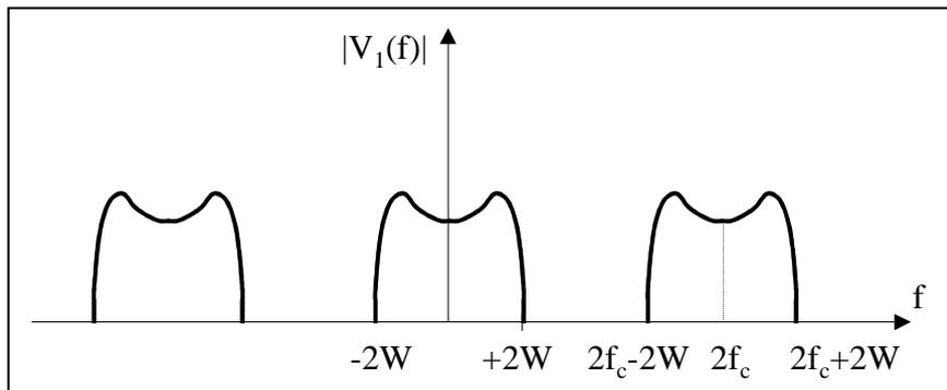
Como la componente de máxima frecuencia de  $r(t)$  (primer sumando) es  $2W$ , vemos que estableciendo un filtro paso de baja con una frecuencia de corte de  $2W$  eliminaremos completamente el segundo sumando y conservaremos íntegramente el primero. En definitiva
