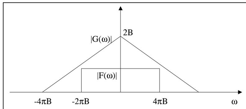
Apartado b). Para determinar la expresión temporal de las señales de entrada y salida no hay más que calcular las transformadas inversas de los espectros. En concreto para la entrada tenemos
