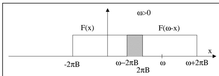
Teniendo en cuenta que el espectro de entrada es de valor unitario, el valor de la integral para un determinado valor de  $\omega$  es el área rayada en el dibujo. Con ello el producto de convolución queda
