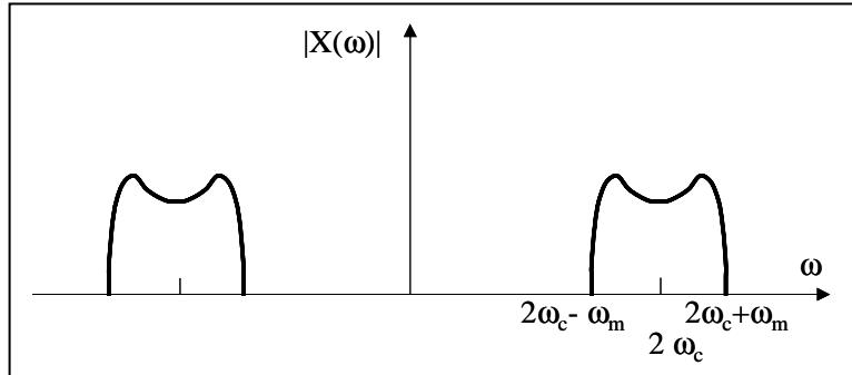
Este espectro se corresponde con el de una señal modulada en amplitud en Banda Lateral Doble con la Portadora Suprimida, lo que se suele denominar DSB-SC.
