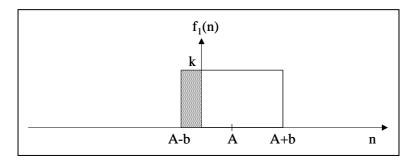
En esta gráfica el área rayada se corresponde con la probabilidad de que la señal en el receptor, después de que se la haya añadido el ruido del canal, sea menor que cero. Si
