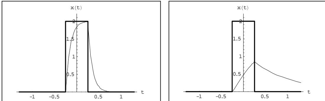
La condición que debe cumplir pues el ancho del pulso es que permita a la señal de salida alcanzar el valor de la tensión umbral. Sea un pulso de alto  $A$  y ancho  $d$ . La tensión de salida vale inicialmente cero y, en la fase de subida se comporta de acuerdo con la ecuación
