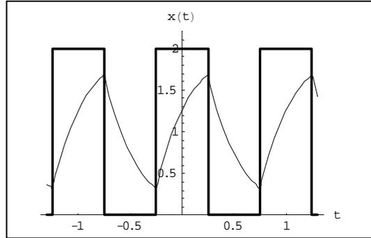
Supongamos que el circuito RC se excita con una onda cuadrada como la de la figura con un valor mínimo de tensión de entrada de  $A$  voltios y un valor máximo de  $B$ . La tensión de salida evoluciona en una especie de diente de sierra con un valor mínimo de  $y_{min}$  y un valor máximo de  $y_{max}$ . Fijémonos en primer lugar en el tramo de subida de la señal de salida que, como en cualquier circuito RC, toma la forma
