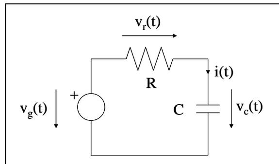
Supongamos que se pasa de un nivel lógico a otro. Por ejemplo, de 0 a 1, o sea, de  $+A$  a  $-A$  voltios. Hay que notar que, un instante antes de la conmutación, el condensador debe estar cargado a la tensión  $+A$ . Resolviendo el circuito con estos datos tenemos las siguientes expresiones:
