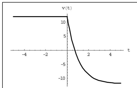
En el instante  $t_c$  en el que termina el período de conducción, la tensión  $v_c$  debe alcanzar un valor que suponga un error menor del 1%. Al no quedar explícito en el enunciado, se supondrá que ese 1% es relativo al recorrido total de la tensión de salida, es decir, a  $2A$ . Esto se puede escribir como
