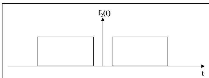
Como podemos comprobar la función resultante  $f_2(t)$  es un tren de pulsos con duty cycle del 75 % y se ha obtenido de otro tren de pulsos con duty cycle del 25% cambiándole de signo y con un diferente nivel de continua. Es lógico, por tanto, que tengan los mismos armónicos excepto el nivel de continua.
