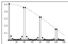
Igualmente las figuras siguientes muestran el espectro de la señal muestreada para un duty-cycle del 12'5 y del 1% respectivamente.
