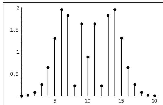
En las figuras siguientes se representan los espectros de las señales moduladas cuando la desviación de frecuencia es, respectivamente, de 0.1, 0.5, 1 y 2 KHz.
