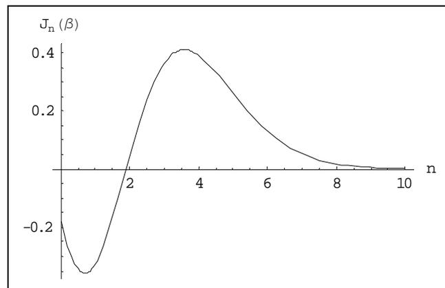
lo que, multiplicado por la amplitud de la portadora, nos da que el espectro de amplitud de la señal modulada para frecuencias positivas que es el siguiente
