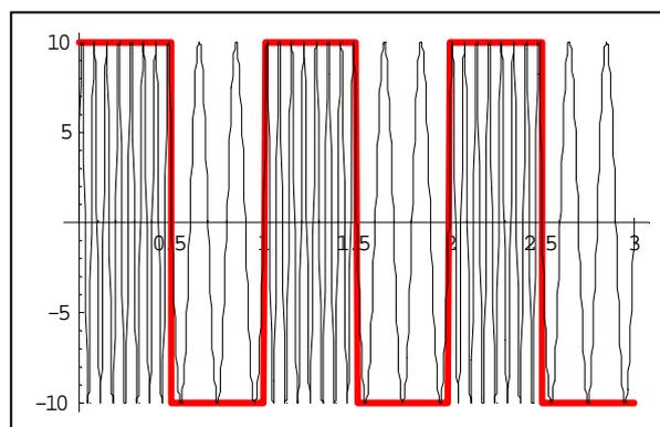
Este hecho nos permite estudiar la modulación en frecuencia de una onda cuadrada como un conjunto de dos modulaciones en amplitud. En efecto, separemos los dos comportamientos de la señal modulada en dos funciones independientes  $g_1(t)$  y  $g_2(t)$  tal como aparecen en las figuras siguientes
