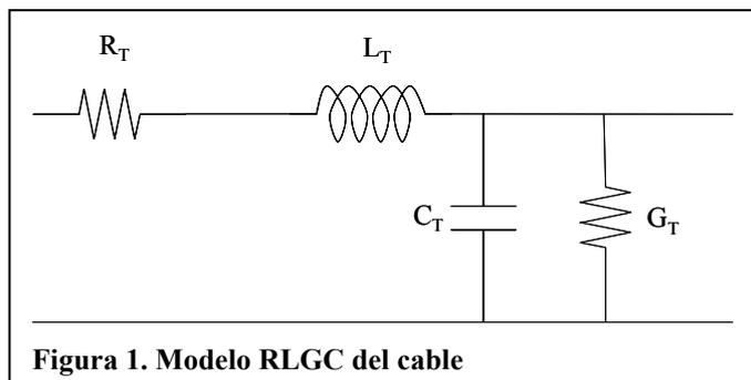
Figura 1. Modelo RLGC del cable
