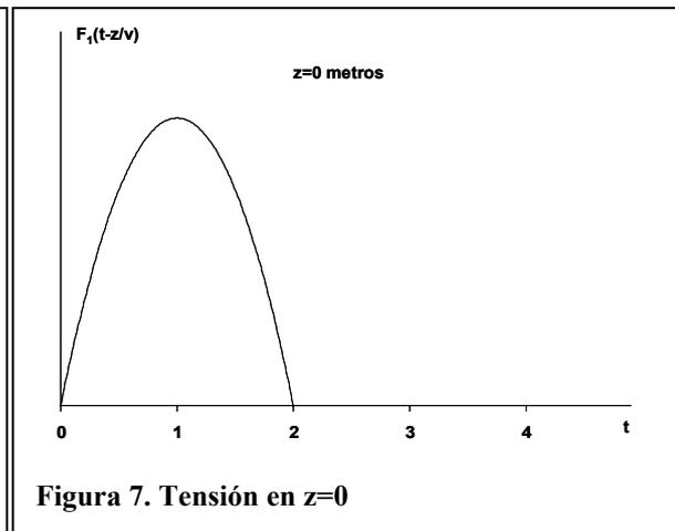
La función  $V_+$  es una onda de tensión que viaja en el sentido positivo del eje  $z$ . Veámoslo. Supongamos que la función  $F_1(x)$  toma la forma que se muestra en la figura 6. Supongamos igualmente que el valor de  $v$  es de 1 metro por segundo. En este caso, el valor de la tensión en distintos puntos del cable ( $z=0$ ,  $z=1$  metro,  $z=2$  metros), queda reflejada en las figuras 7, 8 y 9 respectivamente.
