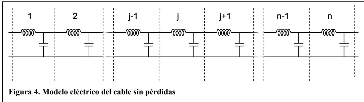
Si suponemos que el cable discurre a lo largo de un eje  $z$  durante una longitud total  $z_T$ , la longitud de cada segmento del cable será
