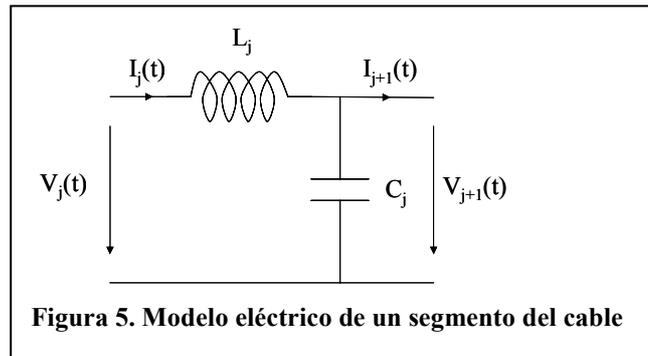
Analicemos el comportamiento de un segmento del cable tal como el mostrado en la figura 5. Se tiene que
