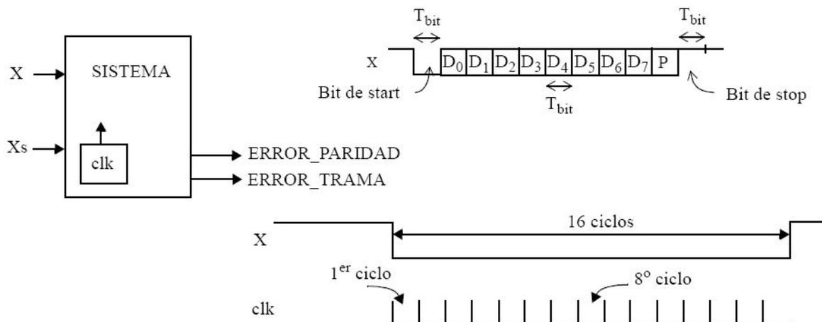
Se desea diseñar un sistema digital capaz de recoger los bits de datos en este formato y almacenarlos en el registro  $RCREG$ . El reloj del sistema es mucho más rápido que la señal  $X$ ; en concreto, el periodo es de  $T_{bit}/16$ , esto es, existen 16 ciclos de reloj por cada bit de entrada. Tras la activación de la señal  $X_s$  el sistema operará de la forma siguiente:
