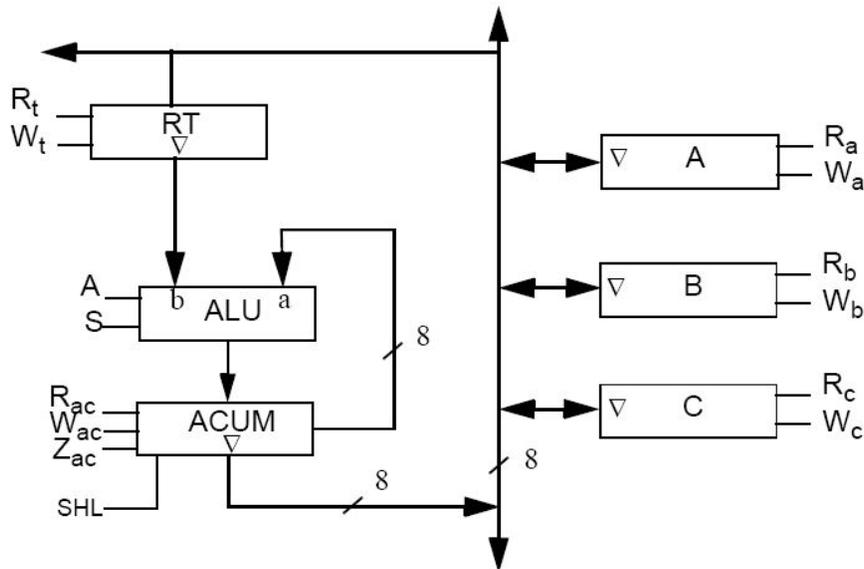
Obtenga la carta ASM de un controlador que permita realizar la operación de rotación de la información almacenada entre los registros A, B, C de la siguiente forma:
