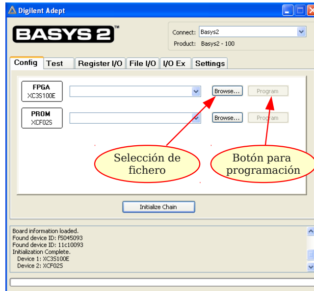
Figura 24. Programación de placas Digilent con Adept.
