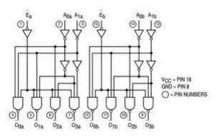
Conexionado interno del integrado 74LS139
